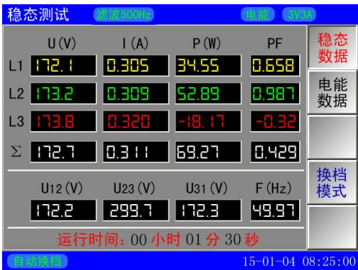
图14-4 滤波后的变频器输出的测量数据
